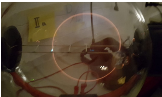
Fadenstrahlrohr: Ablenkung eines Elektronenstrahls
